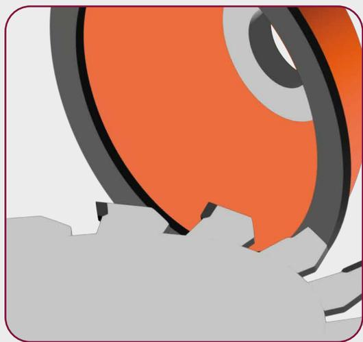
Заточка задней поверхности инструмента
